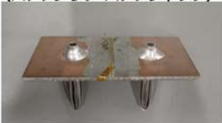
①銅箔厚さ0.035mm 銅板厚さ1.6mm (バナナプラグ+バナナジャック)
