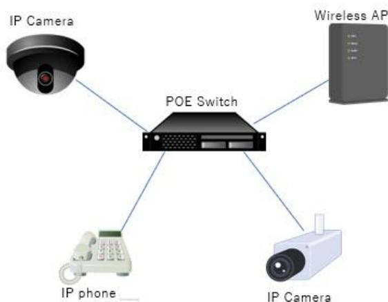
PSE(Power Sourcing Equipment)とPD(Power Device)の動作原理が定義されています。PoE : IEEE 802.3af / POE+ : IEEE 802.3at で規定。
