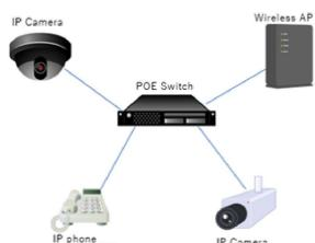
PoE : IEEE 802.3af 中的规定；/PoE+ : IEEE 802.3at 中的规定。定义了 PSE (供电设备) 和 PD (电源设备) 的工作原理。
