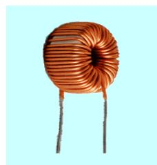
从线圈中产生的磁力线不会向外扩散，因为它通过线圈内的磁芯形成了一个回路。最近，随着产品的小型化迅速发展，为了避免每个相邻组件的影响，首选使用闭合磁路式线圈。
